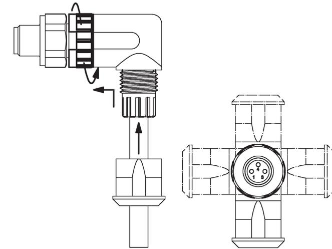
8. Verschrauben Sie die Überwurfmutter bis auf Anschlag.
