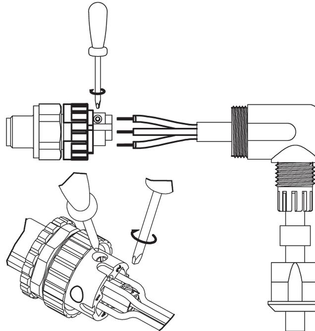
6. Verschrauben Sie das Gehäuse mit dem Steckereinsatz bis auf Anschlag. Das Gehäuse kann in vier verschiedenen Positionen in 90° Intervallen montiert werden.
