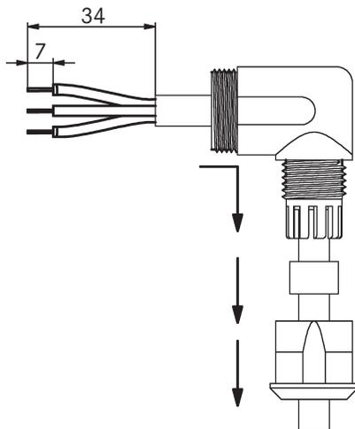
5. Führen Sie die Litzen nacheinander bis zum Anschlag in die vorgesehenen Kammern im Steckereinsatz ein und ziehen Sie die Schraube mit einem Schraubendreher an. Das empfohlene Drehmoment ist 0,3 Nm.
